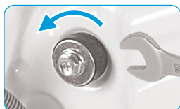
Desserrez les 4 boulons de transport avec une clé.
